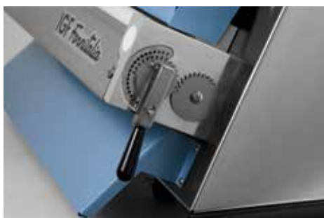
Leva per regolazione apertura rulli macchina mod. 3300/MPZ Lever to adjust roller opening machine mod. 3300/MPZ
