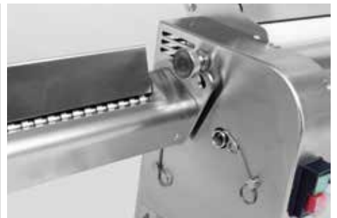
Sistema di aggancio/sgancio accessorio tagliasfoglia Hook/unhook system pasta-cutting accessory
