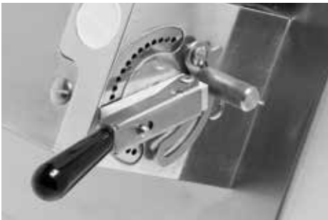
Leva per la regolazione spessore della pasta Lever for the regulation of dough thickness
