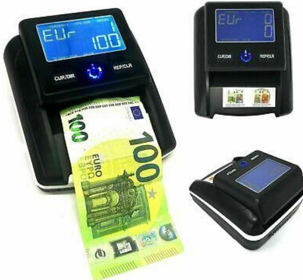
FAST CONTROL è un verificatore di tutte le banconote Euro che esegue tramite lettura magnetica e comparazione dei dati il controllo della presenza del filo di sicurezza, dell'inchiostro magnetico, della dimensione, del colore, dell'infrarosso e dell'ultravioletto.
