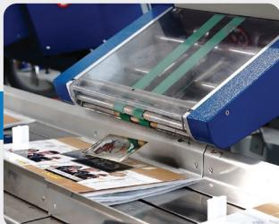
Macchine per l'alimentazione in linea di prodotti e articoli come coupon e gadget. Ideali per essere integrati con attrezzature OEM e linee di confezionamento ad alta velocità e precisione. Ampia varietà di applicazioni.
